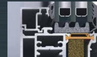
De plus, la mousse isolante placée en périphérie du vitrage ainsi que les barres isolantes en résine phénolique renforcent significativement l'isolation thermique du système, assurant simultanément une bonne ventilation des panneaux.
