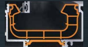
Les profils en PVC réduisent la profondeur visible du dormant, améliorant ainsi la conception élégante du système. Ils contribuent aussi à l'isolation thermique et à l'étanchéité à l'eau et offrent de plus une protection UV qui préserve leur durabilité et leur texture sous une exposition intense au rayonnement solaire.
