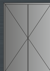
Usa in doua canate batante, placate cu panel izolant
