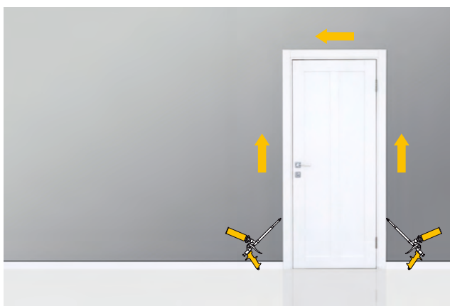
Εικόνα 9.2.2.1Α Τοποθέτηση αφρού πολυουρεθάνης στο πλαίσιο
