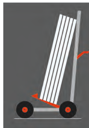
Εικόνα 7.2Α Ασφαλής μεταφορά των κουφωμάτων
